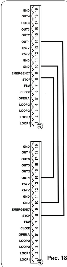
Для последовательно расположенных шлагбаумов установите OUT1 INTERLOCK (блокировка выхода 1) на параметр 18 (см. 2-й уровень программирования) на обоих блоках и соедините их, как показано на рис. 18.
