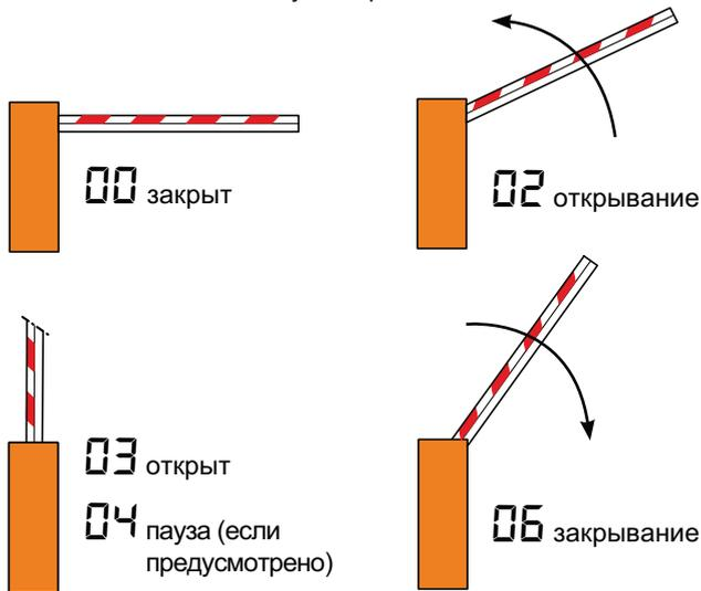
Здесь состояния 01 и 05 не показаны, они соответствуют миганию сигнальной лампочки перед открыванием и закрыванием, соответственно.
