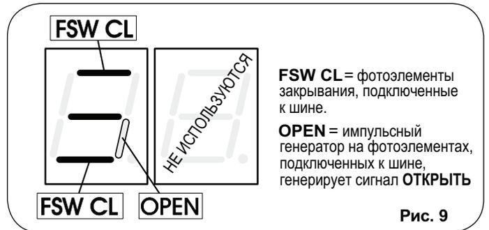
**FSW CL** = фотоэлементы закрытия, подключенные к шине.
