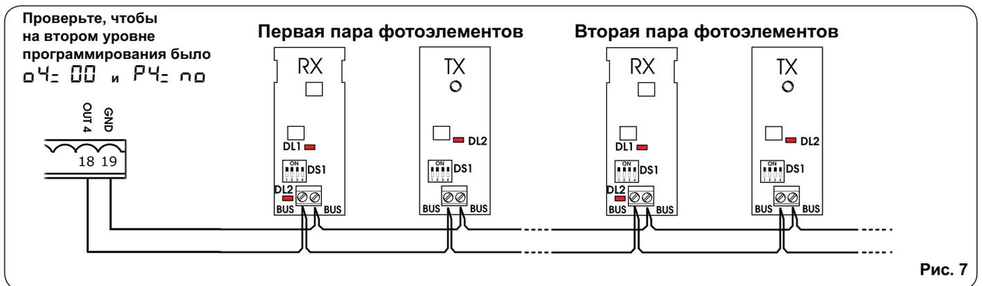
После размещения фотоэлементов с использованием технологии BUS 2easy, выберите адрес каждой пары с помощью комбинации dip-переключателей, находящихся на каждом фотоэлементе.
